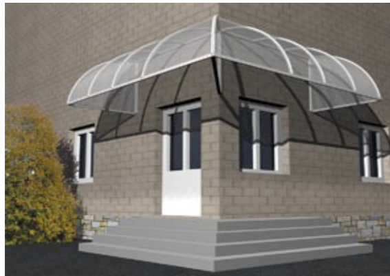
Рисунок 51. Угловая конструкция козырька.
